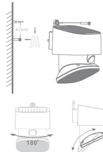
Una volta installato il proiettore LED, prima di attivarlo, lasciarlo spento per 24 ore in modo tale da permettere la carica completa della batteria interna tramite la luce solare.
