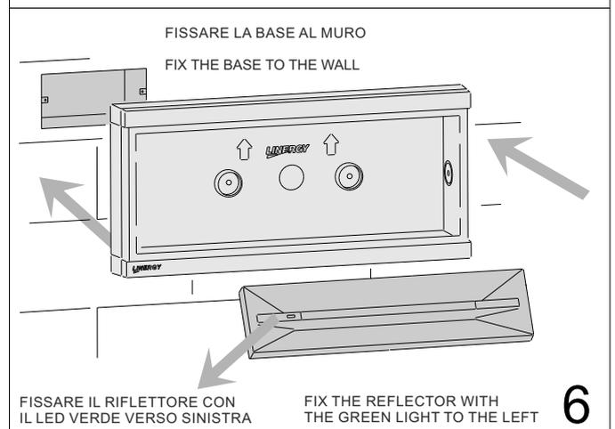
N.B. SUI MODELLI IP65, MONTARE IL RACCORDO PERFETTAMENTE AL CENTRO DELLA PREROTTURA LATERALE ROMPENDO ANCHE LA CORNICE DELLA BASE\*\* (DETTAGLIO FIG.4)
