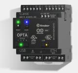
Descrizione tecnica: Opta - Programmable Logic Relay, PLR, 4 uscite, 10 A, Tipo di alimentazione DC, tensione di alimentazione nominale 24 V, funzionamento da 10.2 a 27.6 V, Numero di ingressi: 8 ingressi digitali/analogici, Contatti NO (SPST) - EMR, Versione PLUS, porta Modbus RS485, RJ45 e USB (porta di tipo C), temperatura ambiente da -20 a +55 °C
