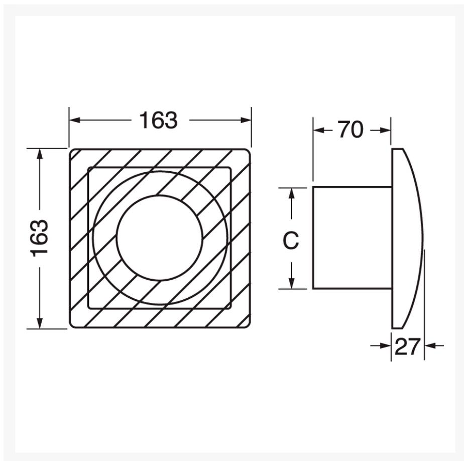
Silenzioso e potente, ad aspirazione assiale. Fissaggio a muro o soffitto mediante tasselli in dotazione. Finitura antistatica a protezione di polvere e sporco.
