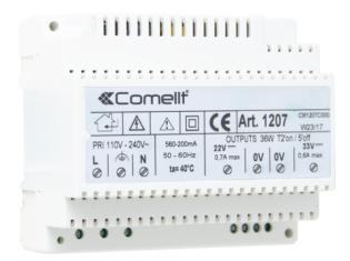
Alimentatore dotato di protezioni per sovraccarico e corto circuito. Prevede 2 distinte uscite in continua: una per alimentare il posto esterno e l'elettroserratura e una per alimentare il monitor. Tensione di ingresso di 120÷230VAC, doppia tensione di uscita di 22 e 33VDC. Dimensioni 106x89x62mm (6 moduli DIN).
