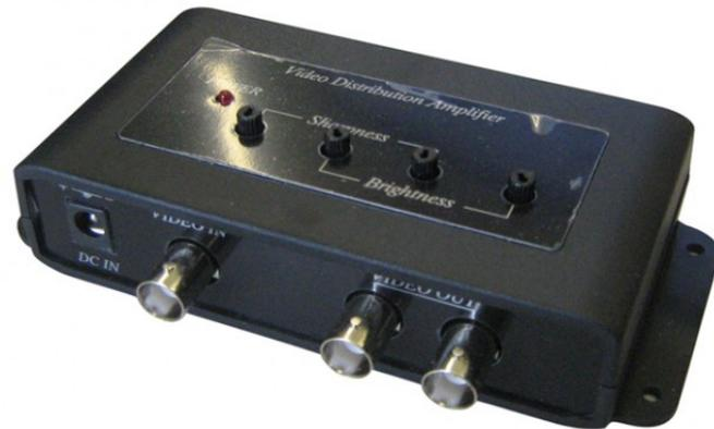
Distributore video amplificato, 1 ingresso video, 2 uscite video, distanza raggiungibile con cavo RG59 1000 m, alimentazione 12 VDC, contenitore plastico, alimentatore incluso.
