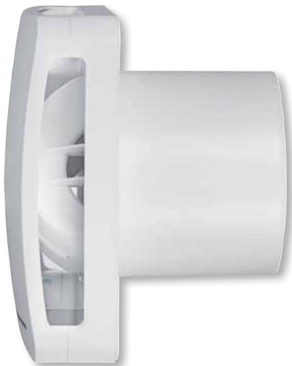
Ventilatori centrifughi concepiti per funzionamento continuo a portata costante e bassa velocità, con la possibilità di passare alla alta velocità mediante interruttore (modelli S e T) o umidostato incorporato (modelli H e M). Assicurarsi che il rinnovamento costante di aria nelle abitazioni unifamiliari. Equipaggiati con motore brushless EC di corrente continua, di rotore esterno, con cuscinetti a sfera, ad alto rendimento e basso consumo, montati nell'ammortizzatore Silent-block.
