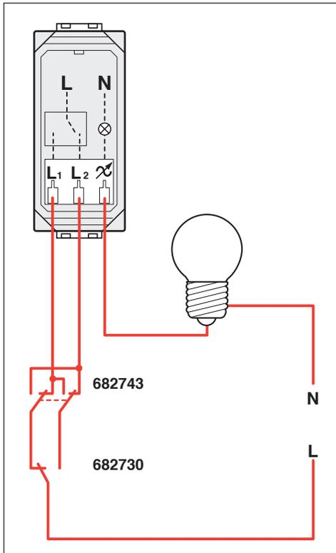
Les conducteurs doivent être poussés au fond du boîtier comme indiqué sur la figure. Éviter que les conducteurs présents dans le boîtier ne soient en contact avec les parois du régulateur.
