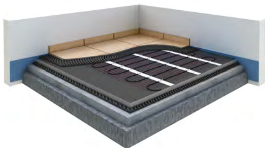
Installazione sotto mattonelle con matassa PFM
